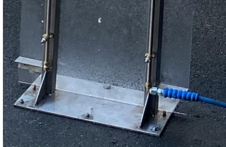
Imagen 2-5. Racor de conexión manguera.
